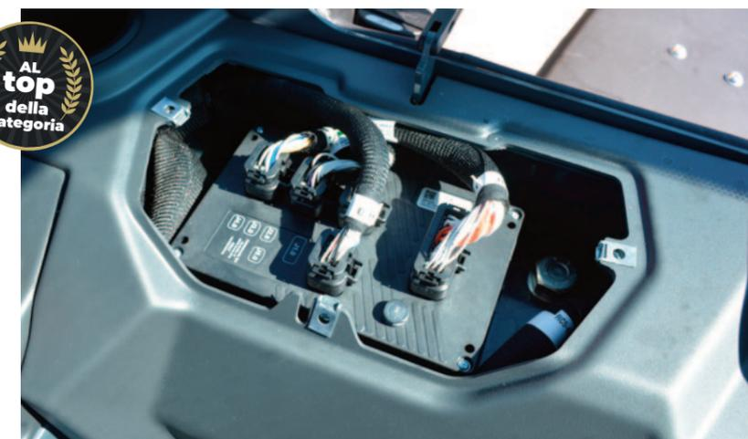
**MAGNI MCU** Alle spalle dell'operatore c'è la centralina principale, made in Italy, che è in rete con ECU motore, centralina trasmissione idrostatica. L'elettronica deriva dalla stessa dei Magni più grandi ed è quindi ampiamente collaudata.
