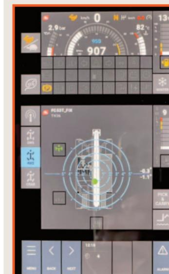
**IN BOLLA** In testa alla schermata che indica l'inclinazione della macchina, c'è la parte principale della strumentazione di bordo.
