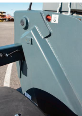
**RINFORZI TELAIO** Sopra, si notano gli scatolati trapezoidali che rinforzano il telaio principale dal punto di incernieramento braccio verso l'asse posteriore.
