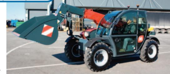
**PIATTAFORMA DA STABILIMENTO** La predisposizione del TH 3.6 per l'utilizzo della cesta porta persone Magni (1.400x700 mm) è realizzata in linea di produzione in modo da offrire una soluzione cablata, sicura e affidabile nel tempo. La gamma di attrezzature dedicate ai sollevatori telescopici Magni più compatti andrà via via crescendo.
